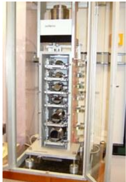
Automatické zariadenie na kalibráciu súprav závaží v rozsahu 1 kg až 10 kg vyrobené na objednávku NMi Holandsko, inštalované v lab. hmotnosti NMi Delft
