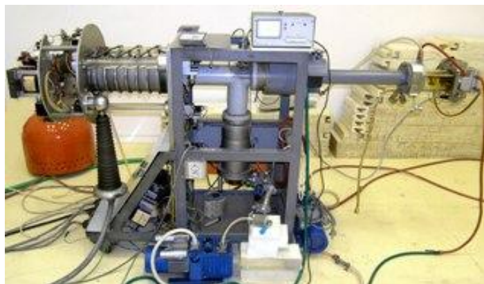
Neutrónový generátor - zdroj 14.8 MeV neutrónov
