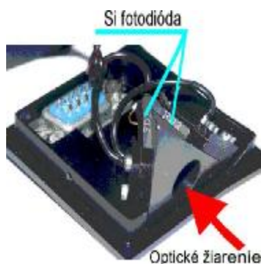
Spektrorádiometer typu TRAP. Označené sú prvé dve fotodiódy a vstupná apertúra. Tretia fotodióda je umiestnená v rovine základne puzdra
