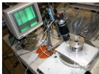
Obr. 3 Zariadenie na kalibráciu uhlomerných šablón
