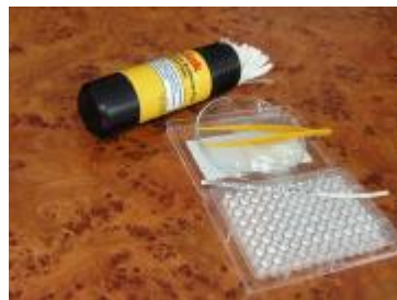
Obr. č. 10 Alaninové dozimetre, cylindrického tvaru (tabletkové) s rozmermi F5 \times 3 mm a páskové – filmové dozimetre s rozmermi 47 \times 4 mm a s hrúbkou 0,3 mm.
