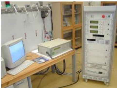
Obr. č. 8 Etalón elektrického výkonu a práce striedavého prúdu
