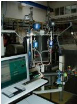
Obr. č. 7 Pohľad na zrekonštruovanú časť Národného etalónu prietoku a pretečeného množstva vody
