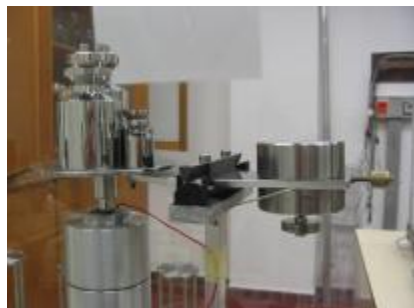
Obr. 5 Riešenie piestového tlakomera s vahadlom
