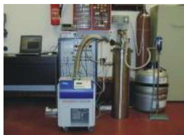
Obr. č. 11 Systém na realizáciu trojného bodu Ar.
