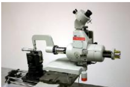
Obr. 2 Zariadenie na kalibráciu mikrometrov
