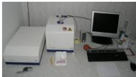
Obr. č. 9 Pracovisko vyhodnocovacieho zariadenia alaninových dozimetrov – EPR spektrometer „e-scan SC0201“ firmy Bruker.
