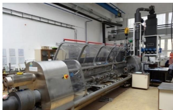
Obr. 7 Celkový pohľad na národný etalón prietoku a pretečeného množstva vody (NE 021/99)
