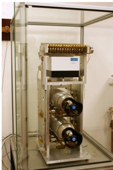
Obr. 12 - Automatický systém na váženie tlakových nádob
