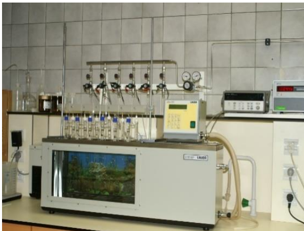
Obr. 15 - Zostava Národného etalónu pH
